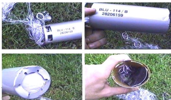
شکل ۴- نمایی از قوطی های خارج شده از بمب اصلی ورشته های گرافیت
